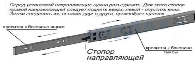
Рис.2 Схема установки шариковых направляющих
