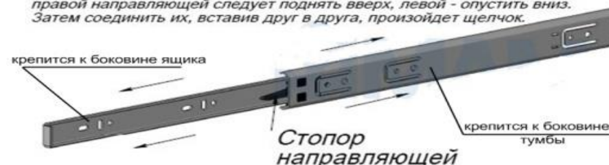
Рис.3 Схема установки шариковых направляющих
